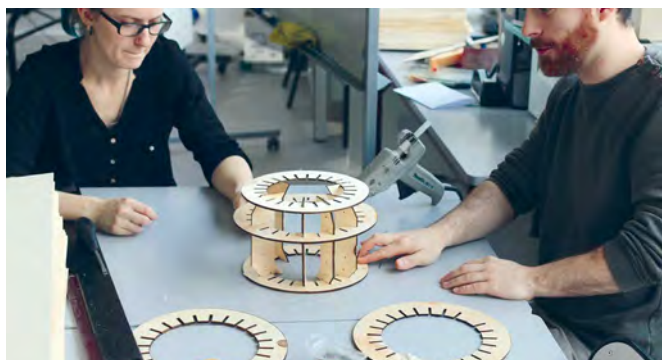
Moule à latte modélisé et découpé au laser au Glass Fablab, utilisé pour la villa Majorelle
