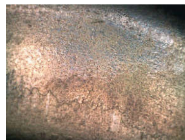
Figure 10 : état de surface de l'empreinte au bout de 1250 pressage
