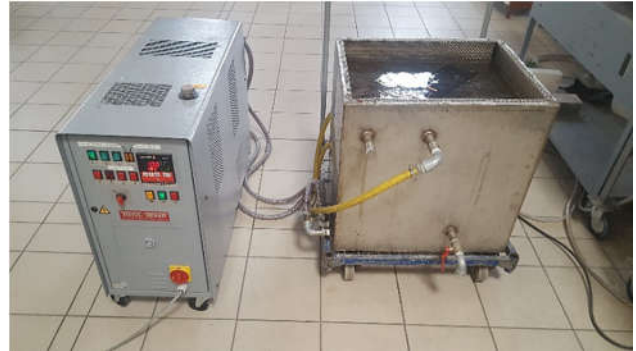
Figure 6 : Bac de trempage à l'eau d'ICAR
